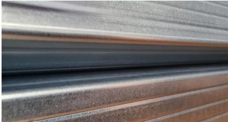
Abb. 1: Trocken gelagerte Profile – keine Gefahr von Weißrost.
